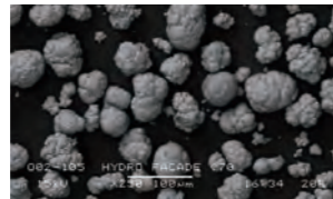
FLASH pearl (calciumcarbonaat) Gemiddelde diameter van een deeltje: 54 µm Rasterelektronenmicroscop, beeldvergroting x150.
